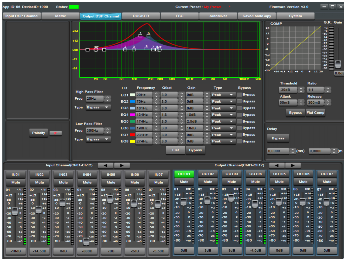
Abb. 22 Ansicht „Output DSP Channel“
